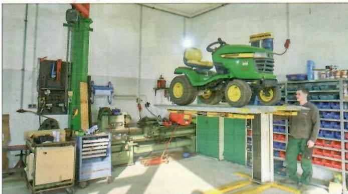
Das Unternehmen Tiefel setzt für bequemes und sicheres Arbeiten auf technische Hilfsmittel: So gehören die Hebebühne und mittlerweile zwei Kräne zur Werkstatteinrichtung.
